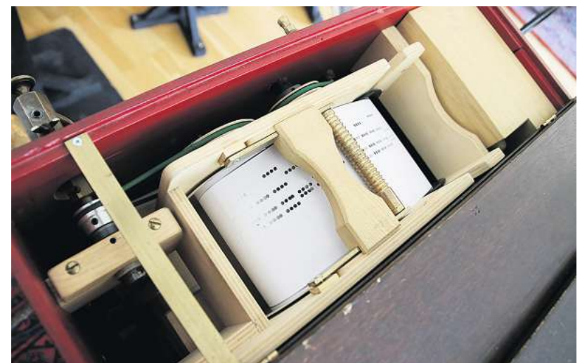
Blick ins Innenleben der Drehorgel: Auf dem gelochten Papierstreifen ist die Melodie des Liedes gespeichert.
