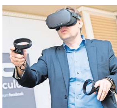
Die Virtual-Reality-Brille Oculus Quest kommt ohne externe Sensoren aus und überwacht die Bewegungen der Handcontroller.
